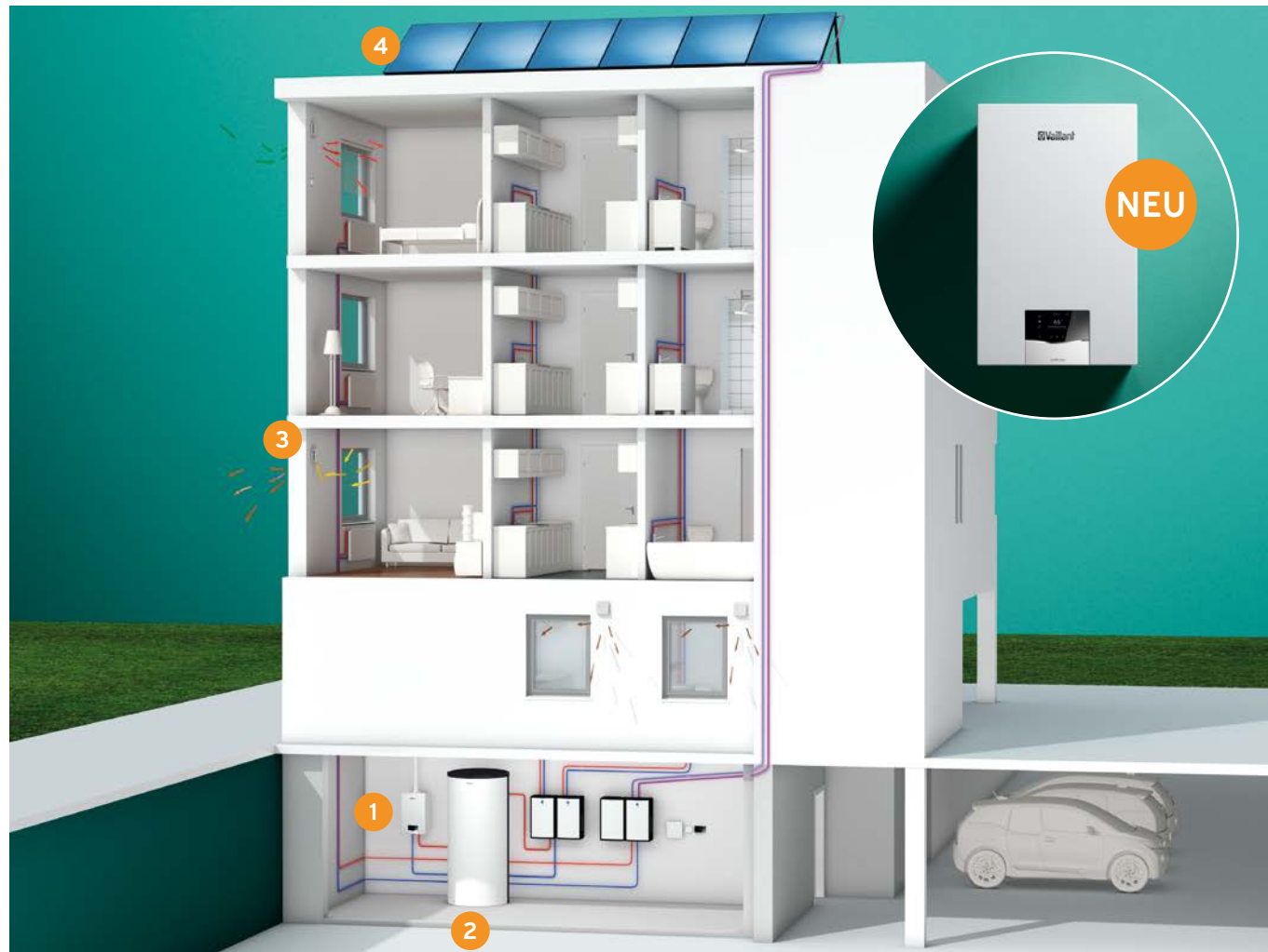
ecoTEC plus VC_/1-5 als Zentralheizung im Keller
